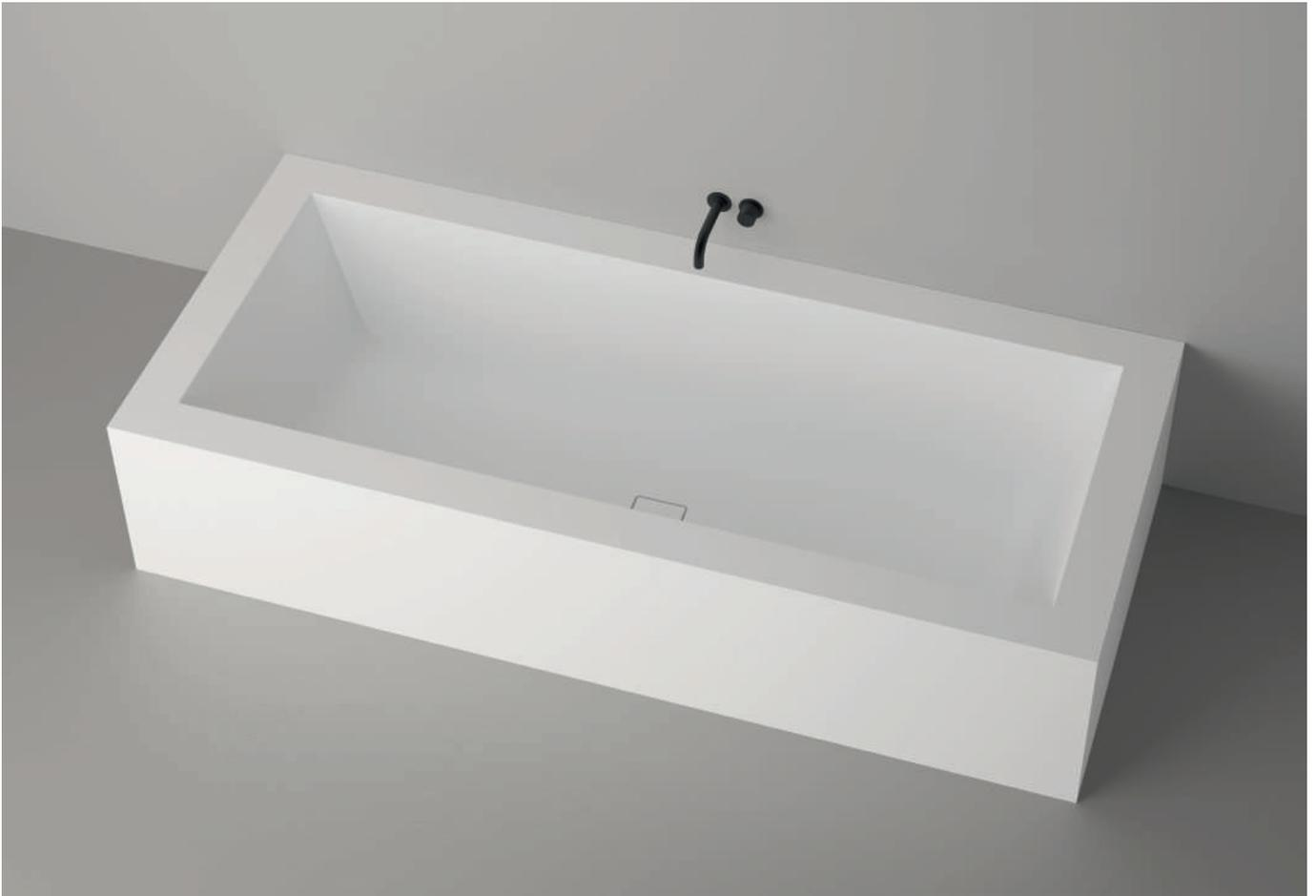
Die dargestellte Wanne zeigt den fugenlosen Einbau des BWP-Wannenkörpers in eine farbgleiche Mineralwerkstoffdeckplatte. Die Deckplatte ist kein Teil des Wannenkörpers und muss in einer Bestellung zusätzlich angefordert werden. Wanne und Deckplatte werden im Hasenkopf-Werk fugenlos miteinander verklebt.
