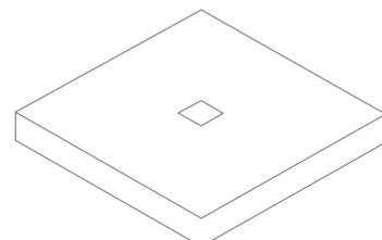
Bei dieser Ausführung muss entweder der Bodenaufbau ausgespart, oder im Estrich eine Installationsbox integriert werden.
