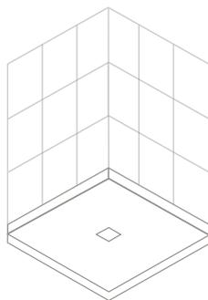
Duschwanne mit fugenloser Mineralwerkstoffaufkantung als Übergang zum Fliesenspiegel
